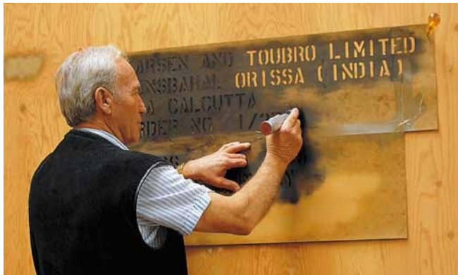
Füllbürsten zum Markieren von Kisten, Jutesäcken usw.
